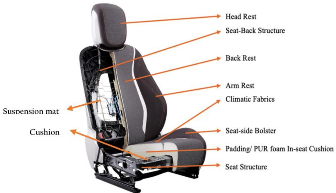
Hình 1. 31 Cấu tạo của ghế lái (Nguồn https://www.researchgate.net )
