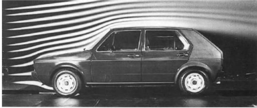
Hình 1.1. Hình dáng khí động học ở phần giữa theo chiều dọc của xe khi không có gió bên
