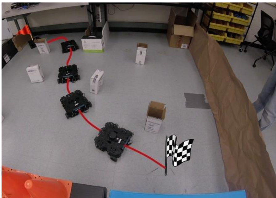
Hình 1.5. Robot tự hành turtlebot 3 tránh vật cản [31]
