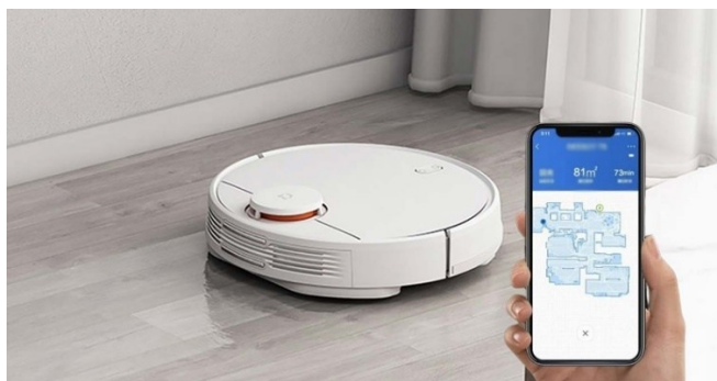
Hình 1.4: Thiết lập tạo bản đồ cho robot lau nhà sử dụng điện thoại thông minh [8]
