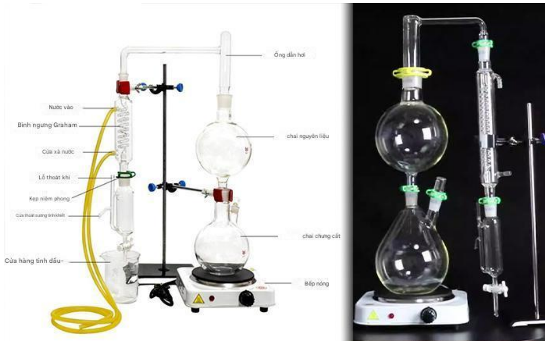
Hình 2.7 Dung cụ chưng cất tinh dầu gừng trong phòng thí nghiệm
