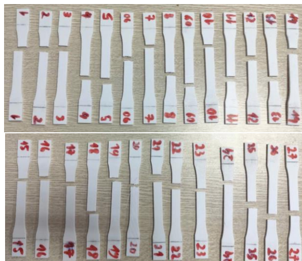
Hình 3.3. Mẫu thử nghiệm kéo với vật liệu ABS
