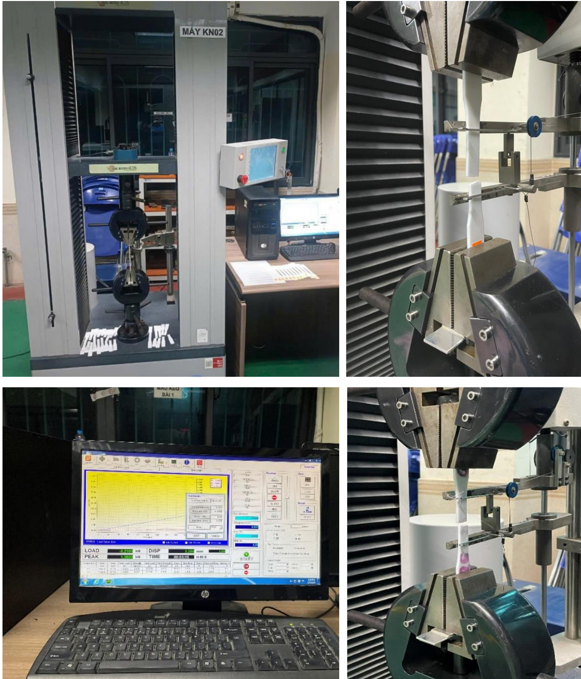
Hình 2.22. Máy thử nén/kéo vạn năng BESTUTM 050MD - Công suất tải tối đa 50kN.
