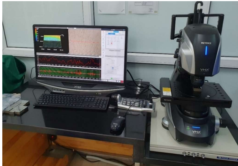
Hình 3.3 Thiết bị đo nhám bề mặt Keyence VHX 7000
