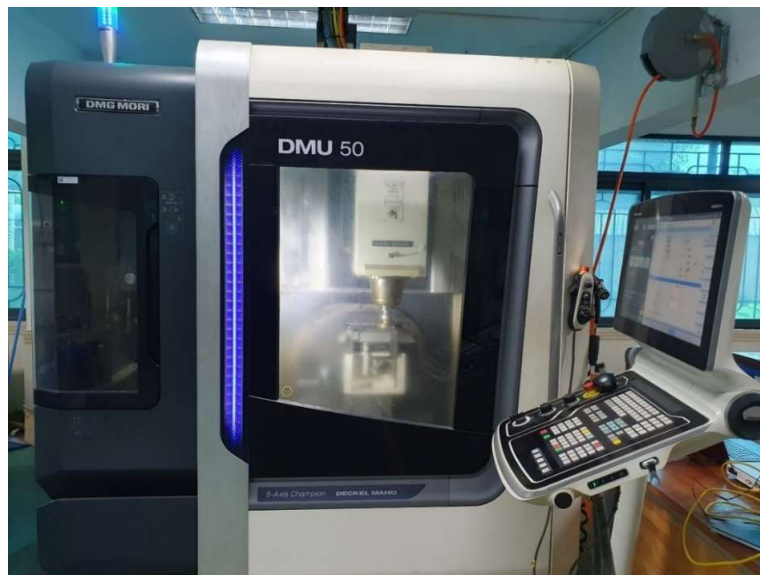
Hình 3.1 Hình ảnh thiết bị thực nghiệm đánh bóng MRF hợp kim Ti-6Al-4V trên máy CNC 5 trục DMU50
