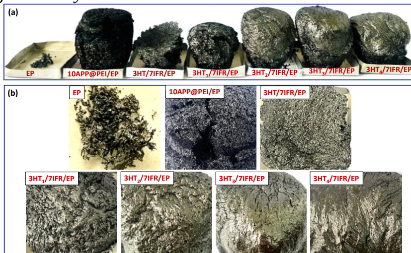
Hình 3.30. Ảnh chụp trực quan lớp than của nhựa EP và các mẫu compozit của nó sau khi nung ở 900 °C: Nhìn ngang (a) và nhìn từ trên xuống (b)
