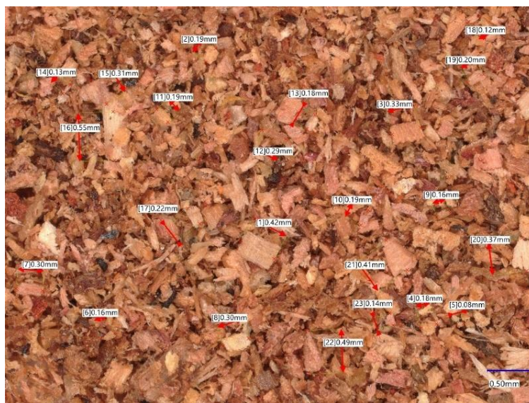
Hình 2- 12. Hình ảnh mìn của trên kính hiển vi quang học Leica độ phóng đại 50 lần
