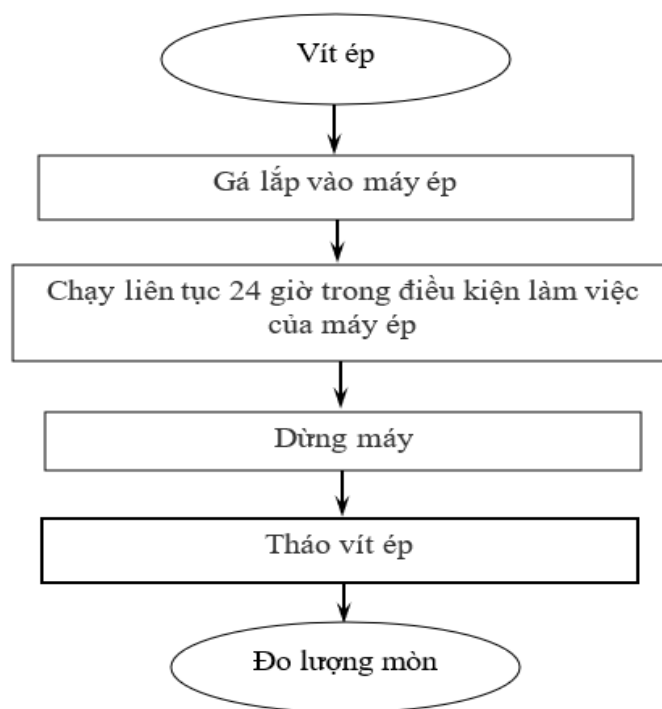
Hình 4- 1. Quy trình thử nghiệm chung
