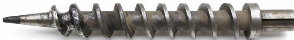
Hình 4- 2. Hình ảnh vít không phủ bị mòn, biến dạng nhiệt
