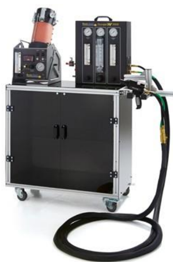
Hình 3- 4. Thiết bị phun HVOF
