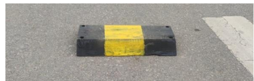
b. Mấp mô biên dạng hình xung được lắp đặt trên đường thử nghiệm
