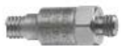
Hình 4.7 CB gia tốc Vibra-Metrics model 1001
