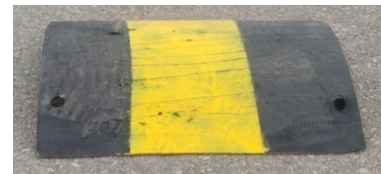
b. Mấp mô biên dạng hình sine chế tạo lắp đặt trên đường thử nghiệm
