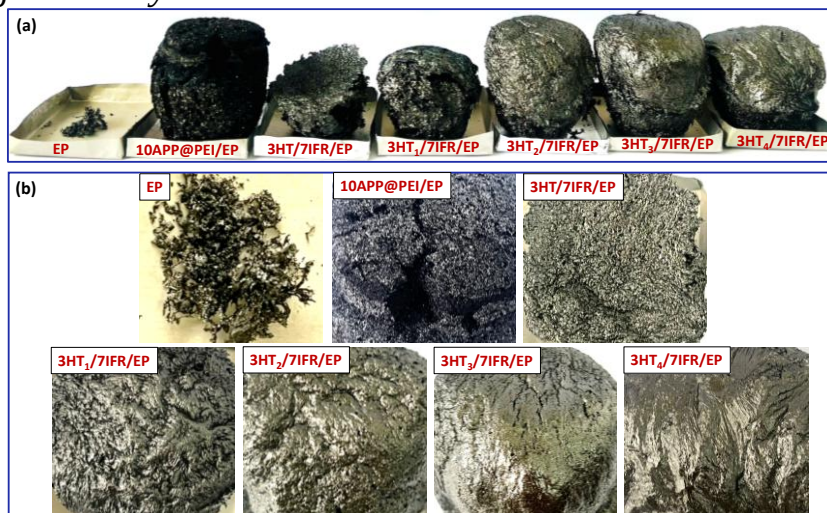
Hình 3.30. Ảnh chụp trực quan lớp than của nhựa EP và các mẫu composít của nó sau khi nung ở 900 °C: Nhìn ngang (a) và nhìn từ trên xuống (b)
