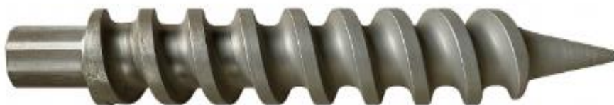
Hình 1- 3. Vít ép dùng trong sản xuất than sạch
