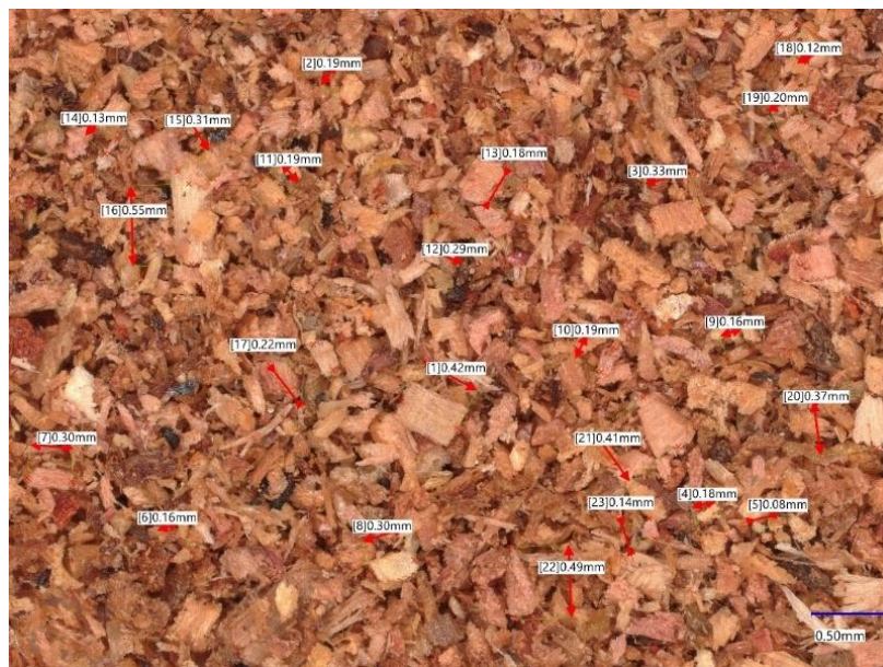
Hình 2- 12. Hình ảnh mùn cưa trên kính hiển vi quang học Leica độ phóng đại 50 lần
