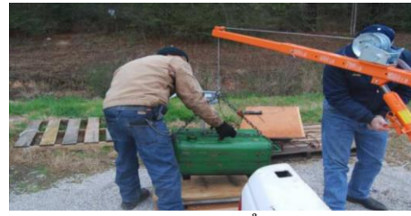
Hình 4.1. Cách đo nhiên liệu xe chạy trên đường theo tiêu chuẩn SAE J1321
