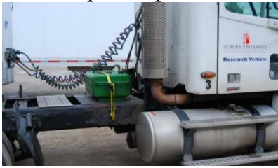
Hình 4.1. Cách đo nhiên liệu xe chạy trên đường theo tiêu chuẩn SAE J1321
